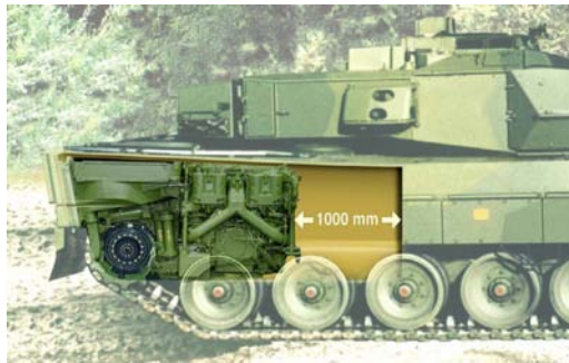
Rys. 1. Objętość zespołu napędowego czołgu Leopard po zastosowaniu zintegrowanego zespołu z silnikiem MT 883 [9]
