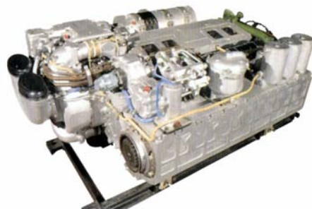
Rys. 9. Silnik z tłokami przeciwbieżnymi 6DT-2 Fig 9. Engine 6DT-2 with opposite pistons
