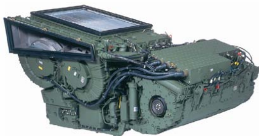
Rys. 8. Zintegrowany zespół napędowy wozu bojowego PUMA z silnikiem MT-892 Fig.8. Power pack for fighting vehicle PUMA with engine MT-892
